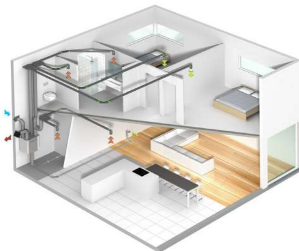
schema di funzionamento dell'impianto di ventilazione forzata
