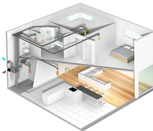
schema di funzionamento dell'impianto di ventilazione forzata
