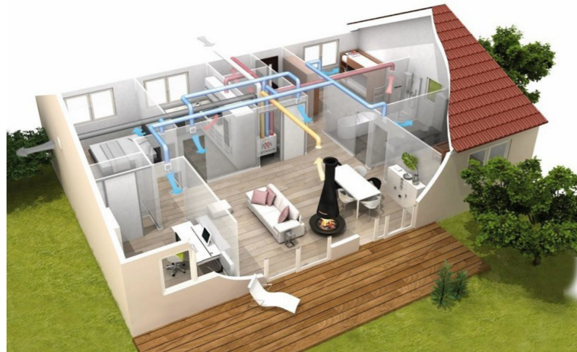
schema di funzionamento dell'impianto di ventilazione forzata
